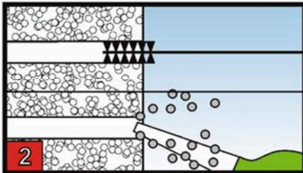
Das Bohrmehl ist aus dem Bohrloch zu entfernen
