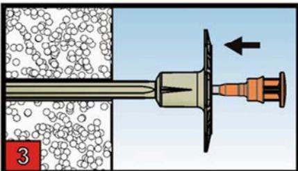
Der Dübel ist bis zur Tellerauflage in den Dämmstoff und das Bohrloch einzuführen
