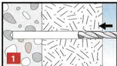
Bohrloch erstellen, unter Beachtung des Bohrverfahrens gemäß Tabelle C 1
